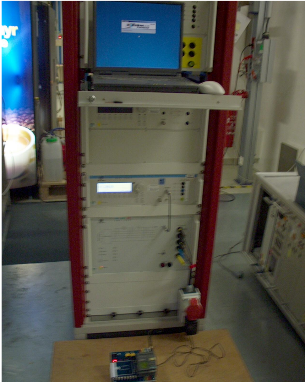
Prüfaufbau zur Beaufschlagung der Stromversorgungsleitungen Test set-up for impressing pulses to power supply line
