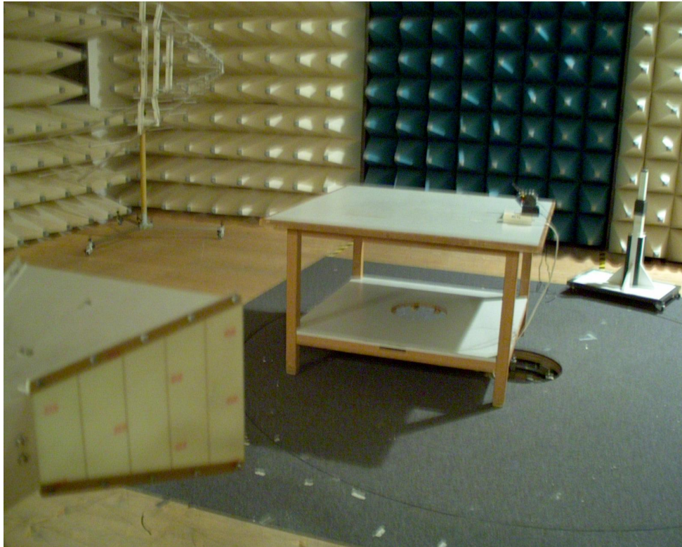
Prüfaufbau für den Frequenzbereich 1 GHz - 18 GHz Test set-up for the frequency range 1 GHz - 18 GHz
